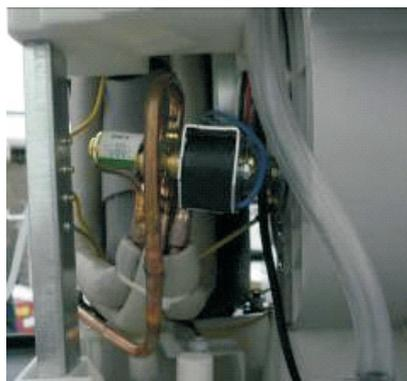
Desconectar o cabo de alimentação da bobina solenóide da válvula reversora da placa eletrônica;
