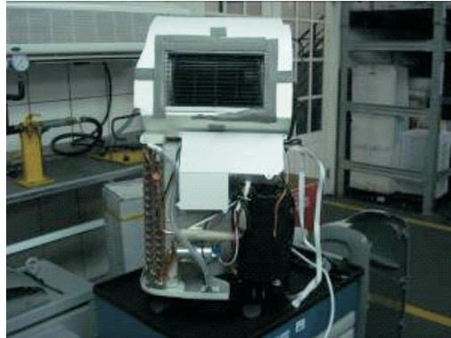
Desconectar todos os cabos conectados a placa e retirar os parafusos que fixam a placa eletrônica na caixa elétrica;
