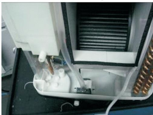
Desconectar o cabo de alimentação da bomba de água secundária da placa eletrônica;
